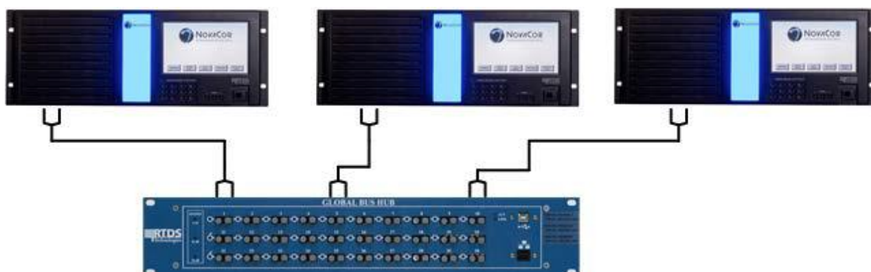
Подключение модулей NovaCor к концентратору GBH
