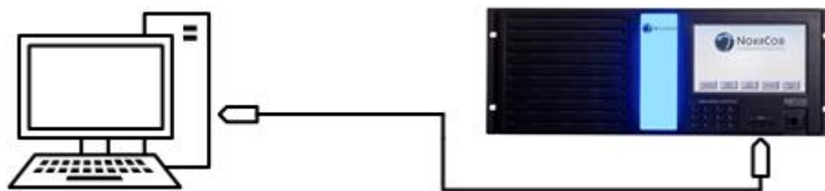
Подключение модуля NovaCor к управляющему ПК
