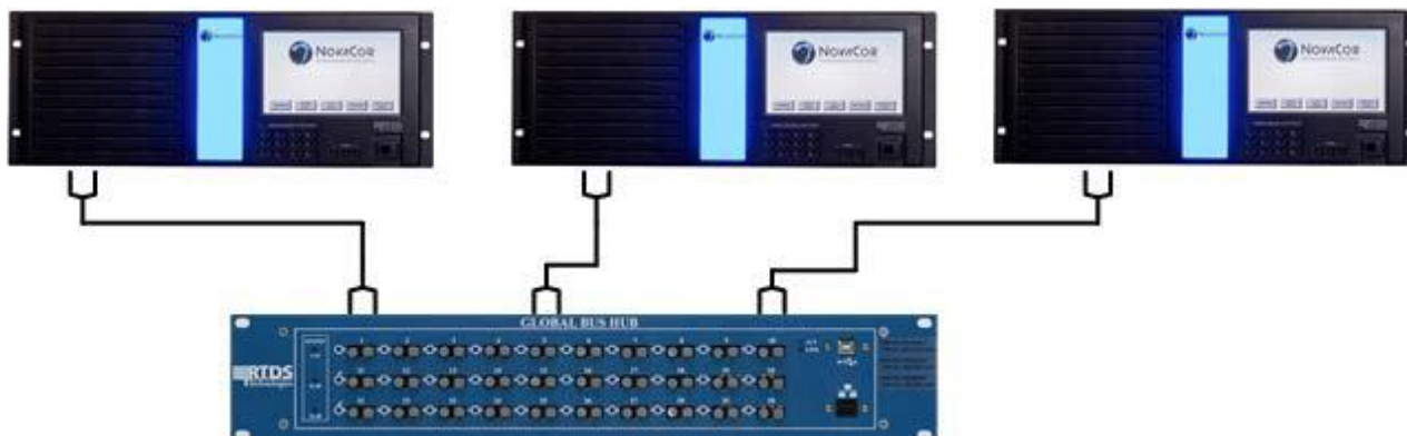
Подключение модулей NovaCor к концентратору GBH
