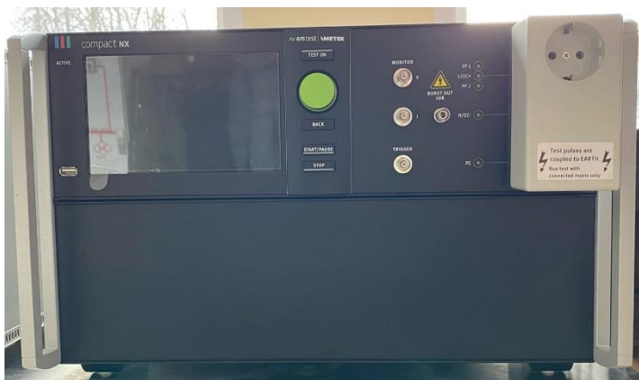
Испытательное оборудование EM TEST Генератор импульсных помех
