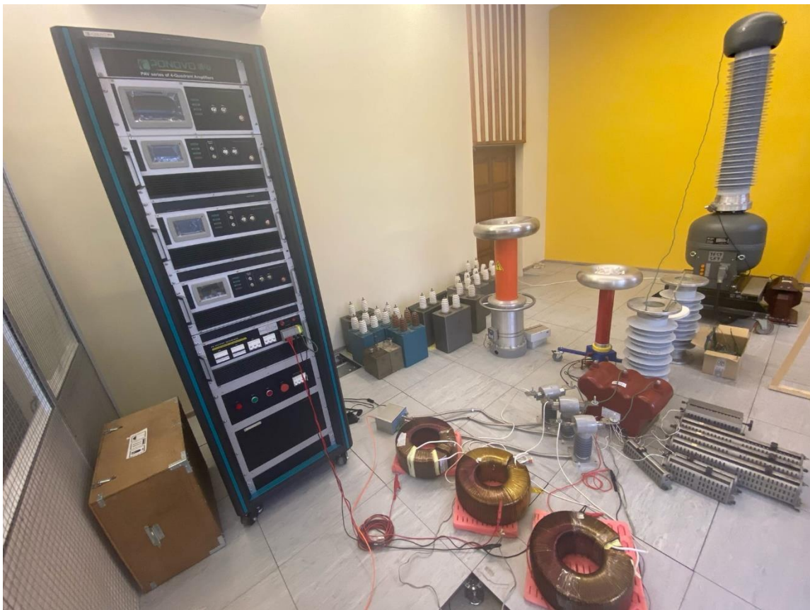
Испытательная схема исследования трансформатора напряжения НАЛИ-НТЗ-10-0,5/0,5/3Р на стойкость к феррорезонансным явлениям с использованием 4Q усилителя напряжения
