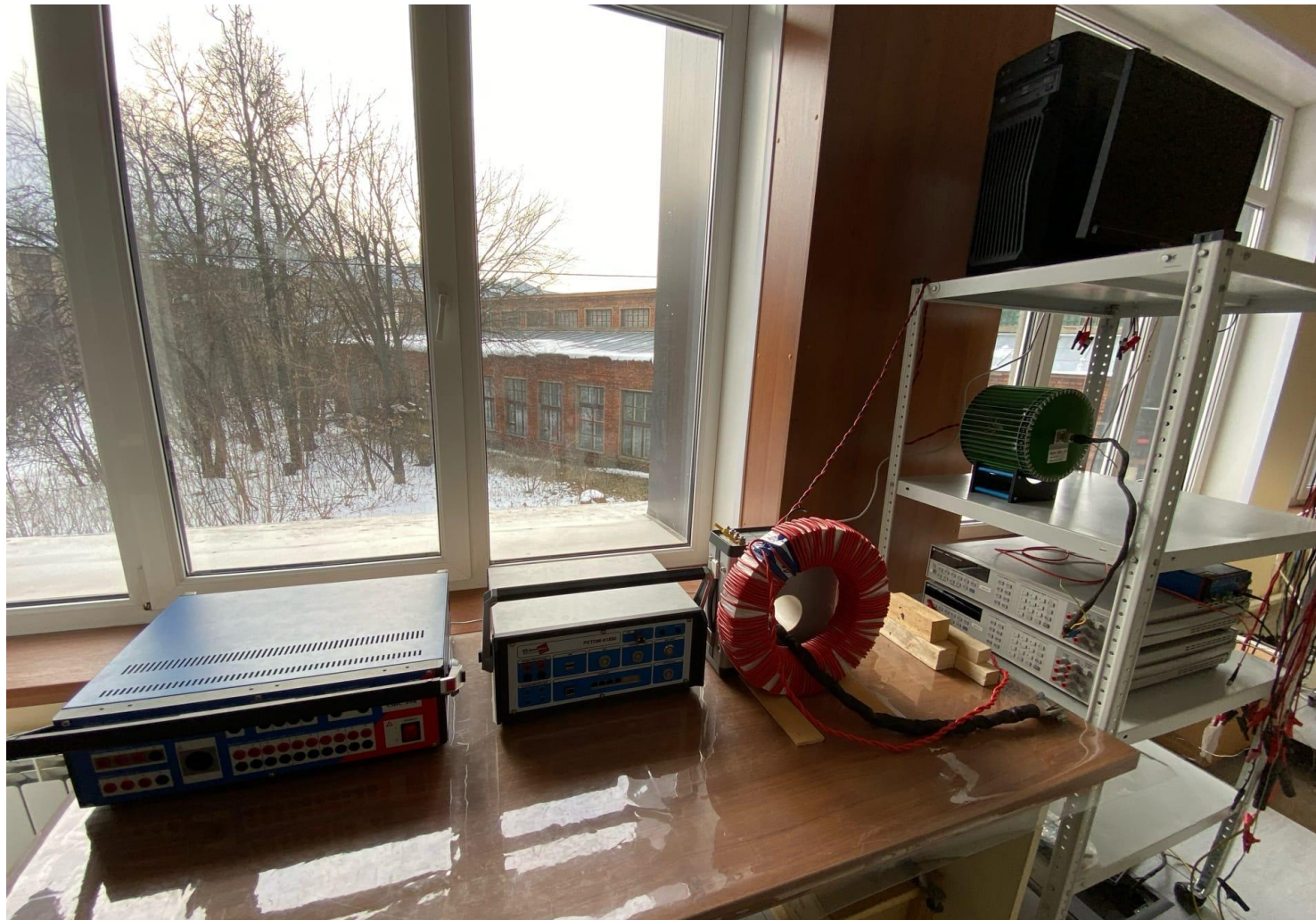
Метрологический ПАК основой являются два полукомплекта мультиметров Keysight 3458A в связке с СМС 356
