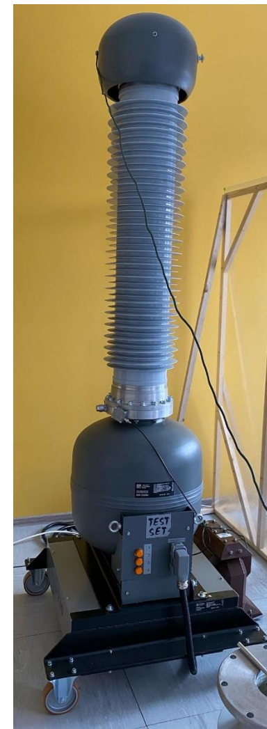
Трансформатор испытательный ИОГ 230/60
