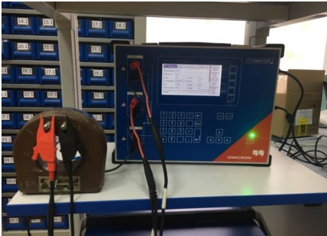
Снятие основной кривой намагничивания (ОКН) с CT-Analyzer
