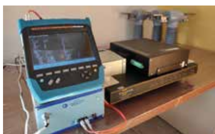
Рис. 5. Установка для испытаний ПАС и цифрового трансформатора
