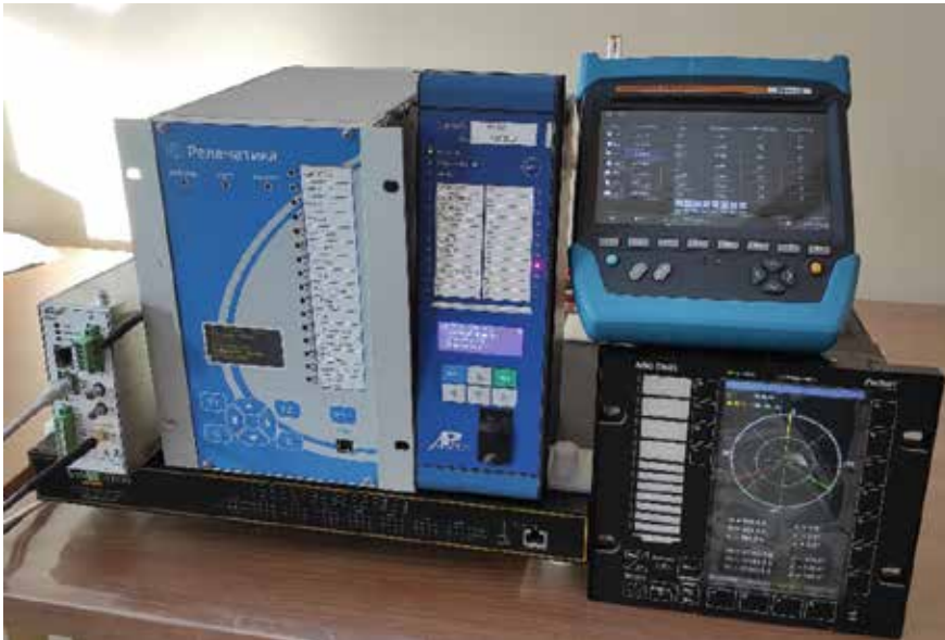
Рис. 3. Фотография установки и схема подключений при испытаниях двух устройств РЗА и счетчика электрической энергии
